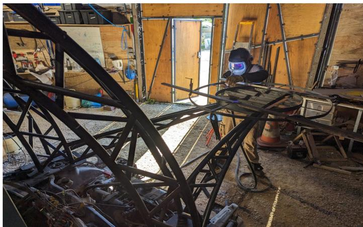
La Machine de ce spectacle est construite sur la base d'une voiture. Elle est constituée de 3 plateformes à différentes hauteurs (de 1,2m à 5m) sur lesquelles les comédiens évoluent en passant de l'une à l'autre par des escaliers en colimaçon. A sa poupe, un portique articulé de 5m de haut, offrant l'accroche pour une corde lisse et des sangles.
